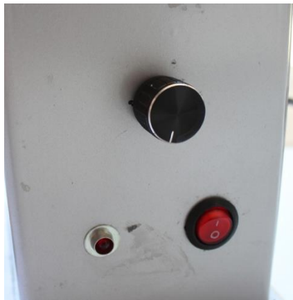
Gambar D.3. Gambar Bagian Pengaturan Homogenizer M1 Keterangan: Kanan=Saklar; Kiri=Indikator Batas Kecepatan Atas=Pengatur Kecepatan.
