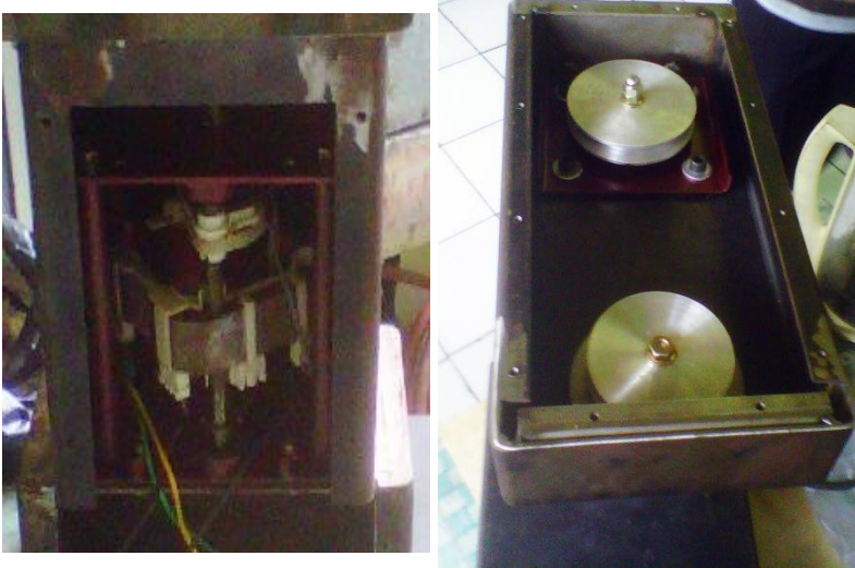
Gambar D.2. Gambar Bagian Penggerak Homogenizer M1 Keterangan: Kanan=Motor Penggerak; Kiri=Pulley Pengatur Kecepatan.
