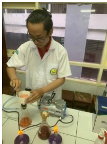
Gambar I.3. Proses penyaringan ekstrak ABD dengan pompa vacuum Sumber: Dokumentasi pribadi (2023)
