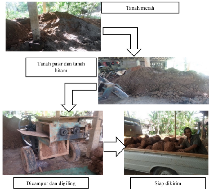
Skema 9 Proses pengolahan tanah sebagai bahan pokok pembuatan gerabah
