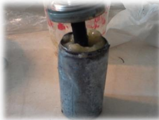
Gambar 1.8. Baterai ditutup dengan elektroda
