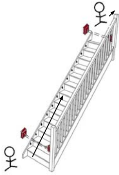
Gambar 19. Ilustrasi saat orang naik tangga dan posisi LED mati dari bawah ke atas
