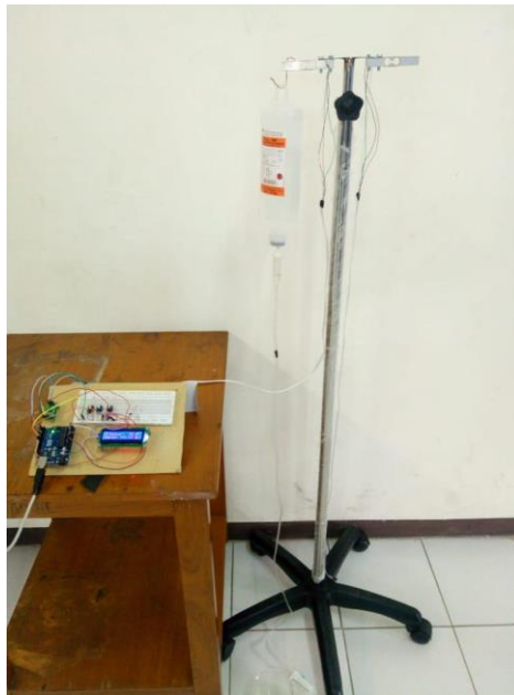
Gambar 9. Sistem penimbangan cairan infus dengan menggunakan modul HX711 dan sistem Arduino dan tampilan LCD
