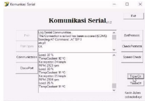
Gambar 3d. Pengambilan data yang berulang selang 1 detik
