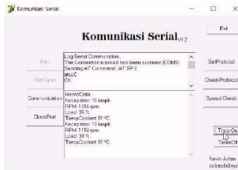
Gambar 3c. Data yang didapat dengan mengirimkan data '010D', '010D', dst
