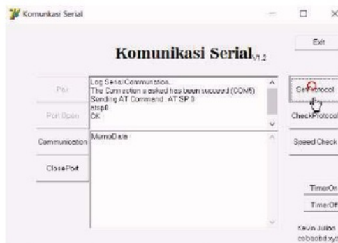
Gambar 3a. Pengiriman data untuk mode AUTO pada OBD-II
