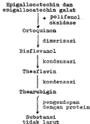
Gambar 5.4. Skema Pembentukan Theaflavin dan Thearubigin Sumber : Harler, 1963
