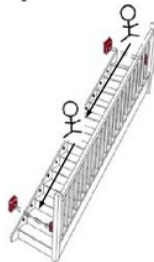
Gambar 18. Ilustrasi saat dua orang turun tangga dan posisi LED menyala dari atas ke bawah
