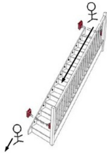
Gambar 22. Ilustrasi saat dua orang turun tangga dan saat LED mati dari atas ke bawah
