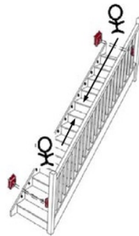
Gambar 18. Ilustrasi saat orang naik tangga dan posisi saat LED menyala dari bawah ke atas, ada orang yang turun
