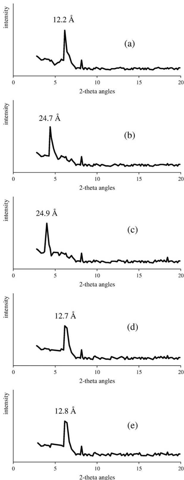
Fig. 1. XRD patterns of (a) B, (b) COC, (c) COM, (d) LOC, and (e) LOM.
